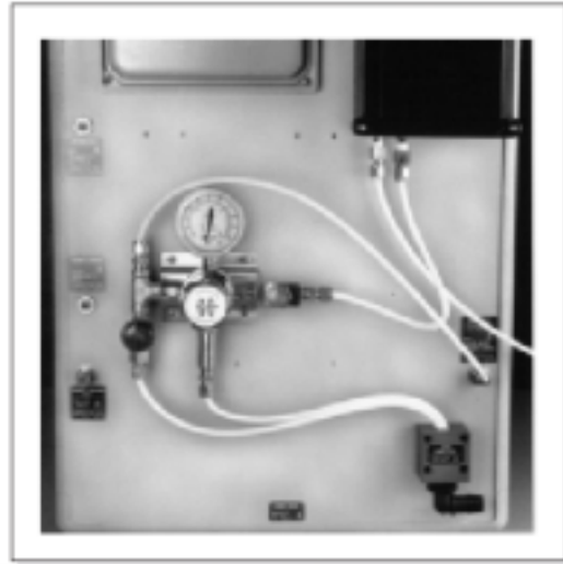
图 14 不锈钢样品压力调节工具包
