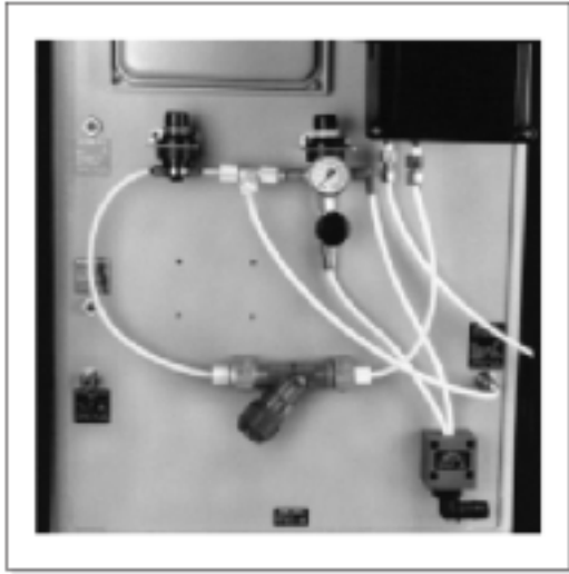
图 13 样品压力调节工具包
